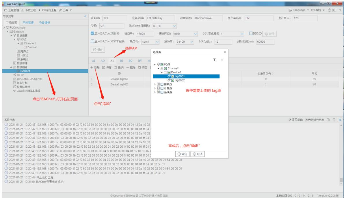
这里使用 BACnetIP服务, 在window是平台使用 选择相应的IP地址; 下载至网关使用选择 相应的网口。
