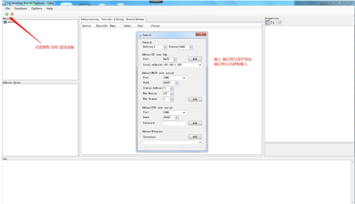
点击“Add”，在Udp:47808节点下有GC中BACnet页面设备ID的设备，说明已经连接上LMGateway的BACnet IP服务，单击此设备节点，就会在左侧中部显示搜索到的所有此设备映射出的BACnet设备和对象。
